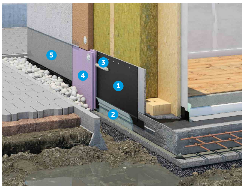
Bauwerksabdichtung im Neubau.
